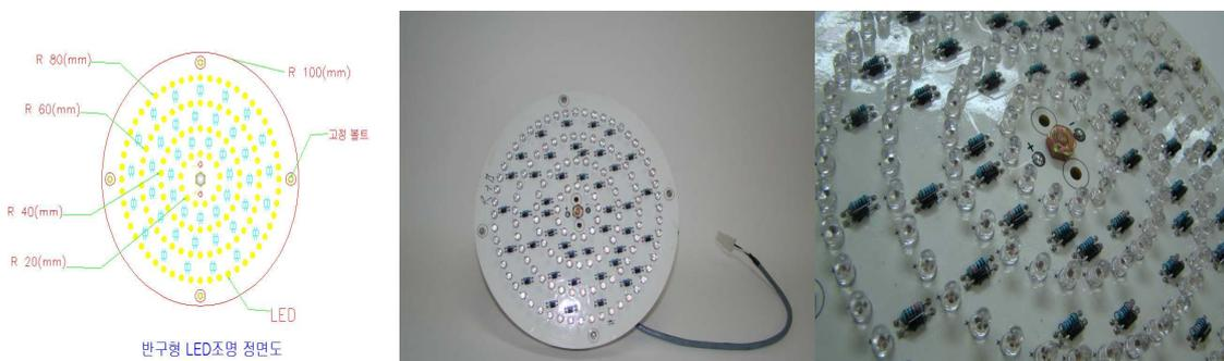
그림 43. LED 조명 설계도 및 조명등 모습
