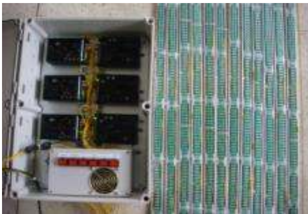
사진 1. 시험에 사용한 LED 및 제어장치
