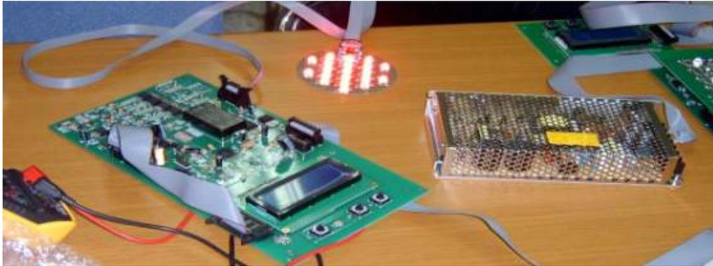
Color Board를 이용한 LED 동작을 확인 하는 과정
