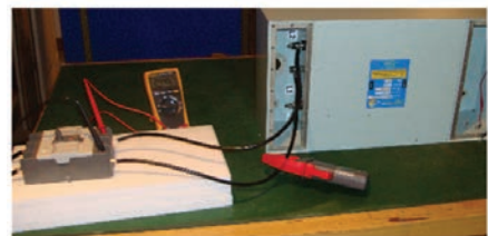
〈그림 9〉 누설전류 측정구성도(上) 및 시험장면(下)
