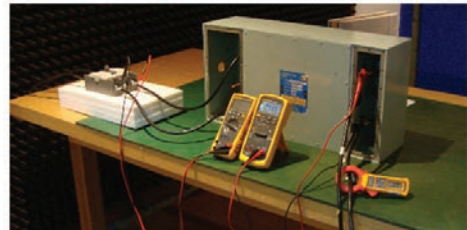
〈그림 8〉 전압강하 측정구성도(上) 및 시험장면(下)
