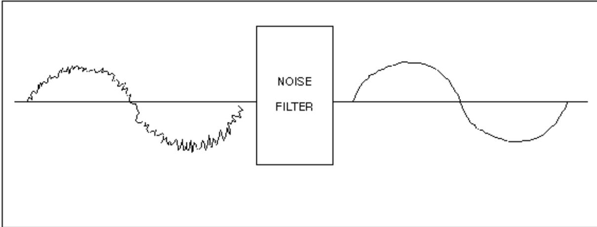
그림(A-1) NOISE FILTER 사용전의 파형
